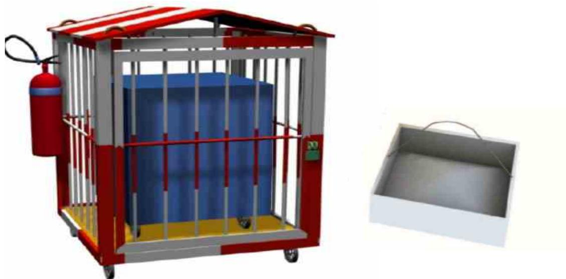
电焊机防护示意图
