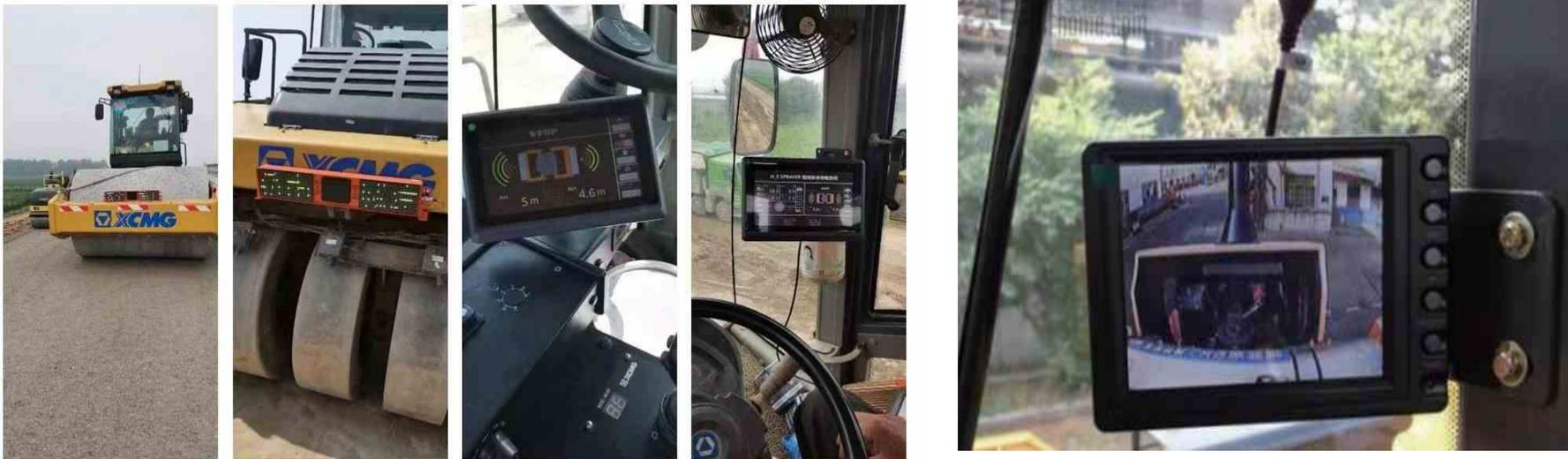
机械自动刹停装置示例图
