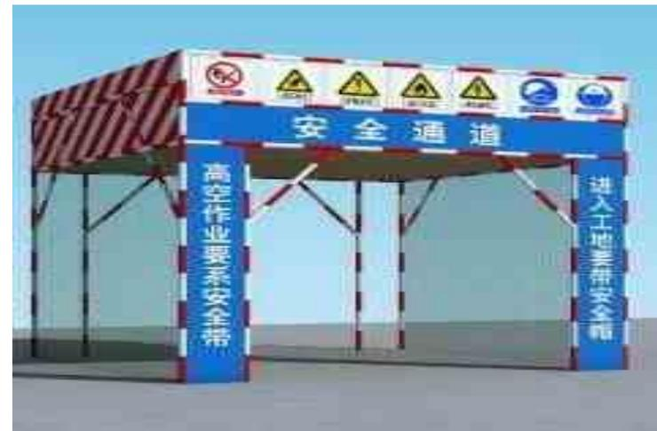
钢管扣件式防护通道示意图
