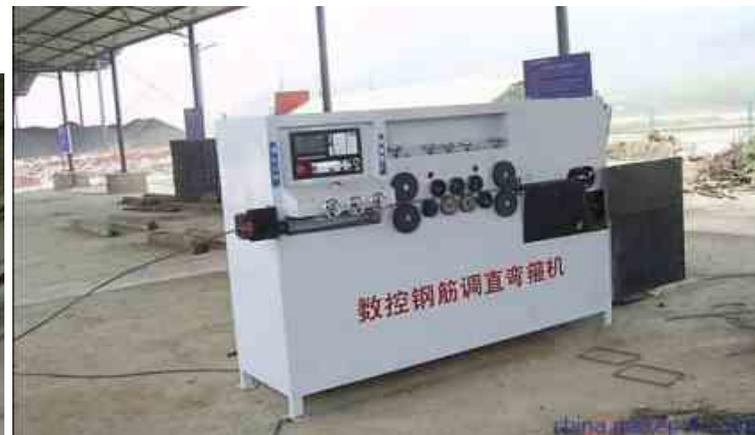
数控钢筋调直弯箍机示例图
